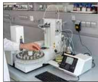
Titrador TitroLine® 7500 KF Trace con horno KF Headspace TO 7280 y pasamuestras TW 7650
